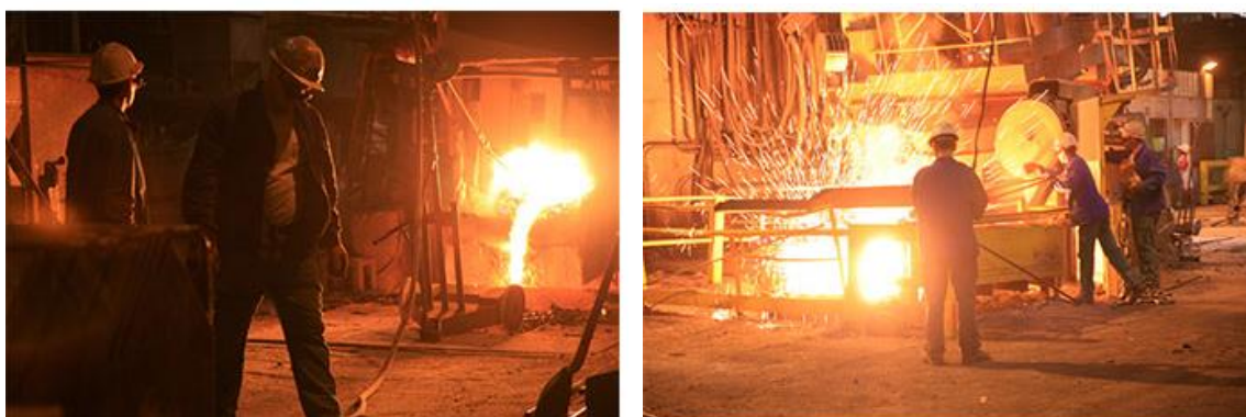
Coulée de métal en fusion après traitement des piles usagées
