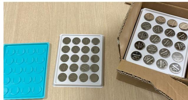
Utiliser l'emballage d'origine des piles neuves ou se procurer ces barquettes avant le remplacement des piles
