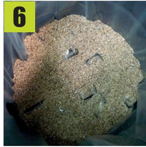
Recouvrir les batteries de vermiculite de manière à **ne plus les voir**.
