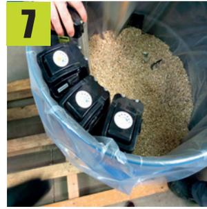
**Aligner une nouvelle rangée de batterie verticalement** (si possible selon la taille des batteries).
