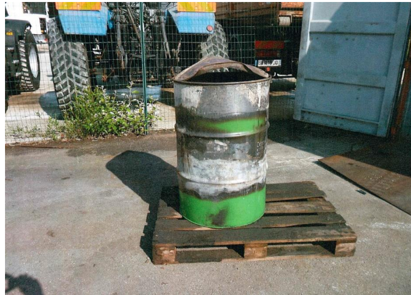
Exemples de fûts de piles bouton ayant pris feu
